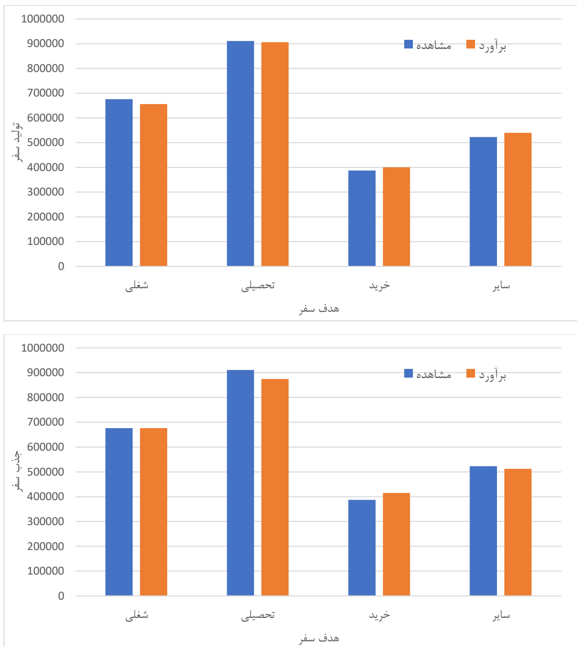
شکل ۴-۲۶- نمودار مقایسه مشاهده و برآورد سفرهای روزانه در مدل های تولید و جذب
